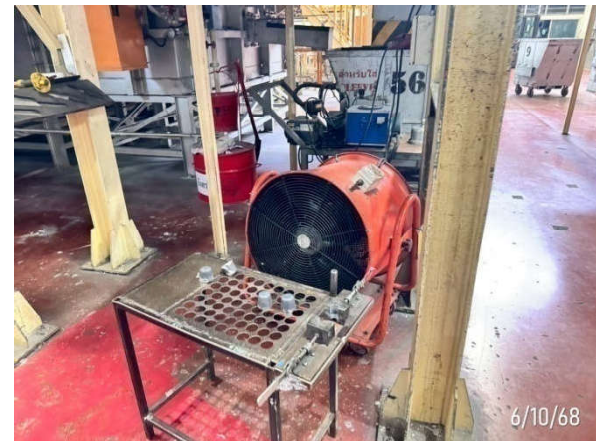
รูปที่ 2-37 พัฒนาระบายอากาศบริเวณพื้นที่เตาหลอม
