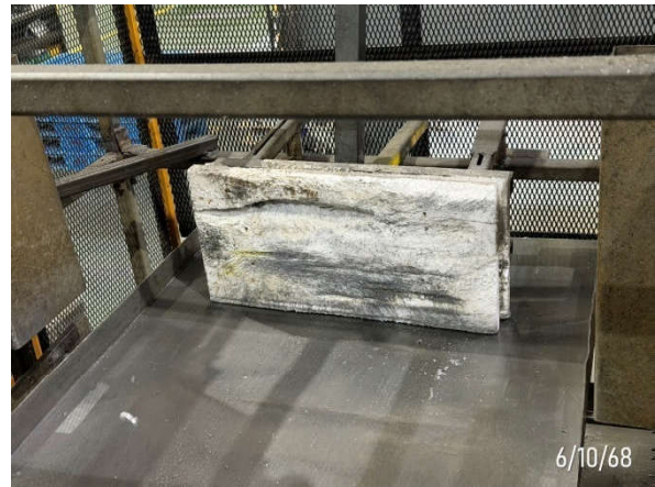
รูปที่ 2-36 การติดตั้งวัสดุกันกระแทก บริเวณเครื่องฉีดขึ้นรูป
