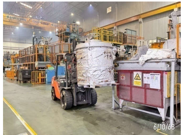
รูปที่ 2-24 พนักงานขนย้ายกาที่บรรจุน้ำอะลูมิเนียม โดยใช้รถยก (Forklift)
